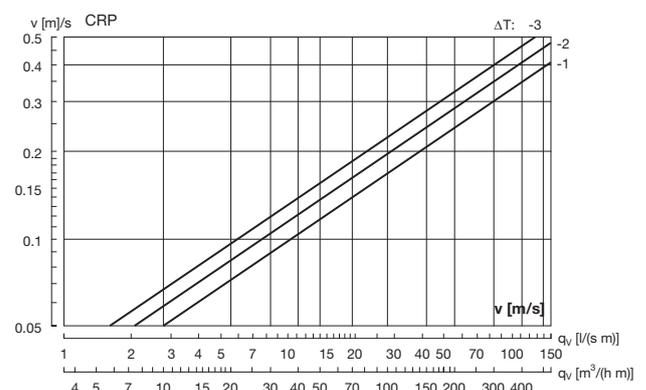
Die Geschwindigkeit wird 0,5 m vom Auslass entfernt gemessen.
