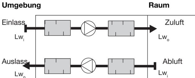
Strömungsgeräusche und Druckverlust hängen von der Geschwindigkeit ( $v$ ) und der Anströmfläche ( $A$ ) des Schalldämpfers ab.
