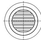
ULA wird mit einem zweiteiligen Schalldämmeinsatz (Ø140/Ø50 mm) geliefert. Wenn eine höhere Leistung benötigt wird, entfernen Sie den inneren Teil des Einsatzes. Die Schalldämmung nimmt um 3 dB ab (siehe technische Daten). Ventile mit kürzerer Einbaulänge für den Einbau in Leichtbauwände können auf Anfrage geliefert werden. Dies führt jedoch zu einer geringeren Schalldämmung.
