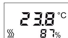
TEMPERATUR-ANZEIGE MIT AKTUELLER VENTILPOSITION, HEIZEN
