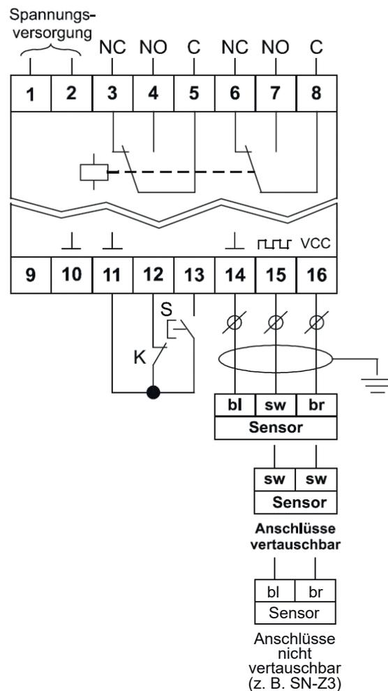
*K = Freigabekontakt vom Motorschutz bei 2-stufigen Ventilatoren Kontakte in Reihe*
