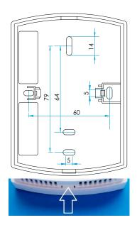
Zum Öffnen des Gehäuses Clip an der Unterseite leicht eindrücken
