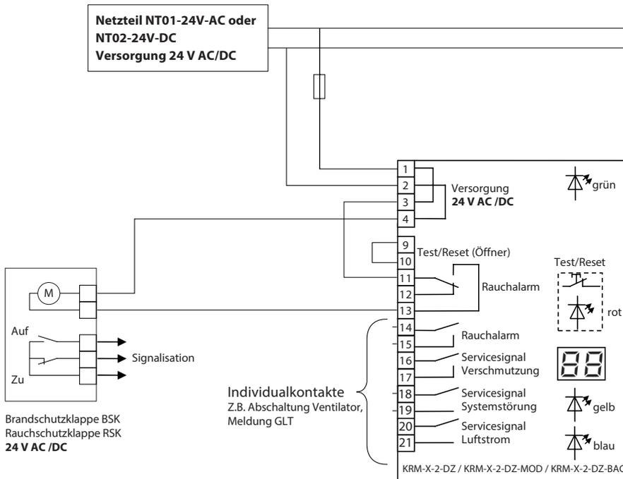
Ausführungsbeispiel mit Versorgung der BSK/RSK über den KRM-X. Alternativ kann die BSK/RSK auch bauseits separat mit Fremdspeisung versorgt werden. Klemme 9 + 10 (Öffnerkontakt für externen Taster)
