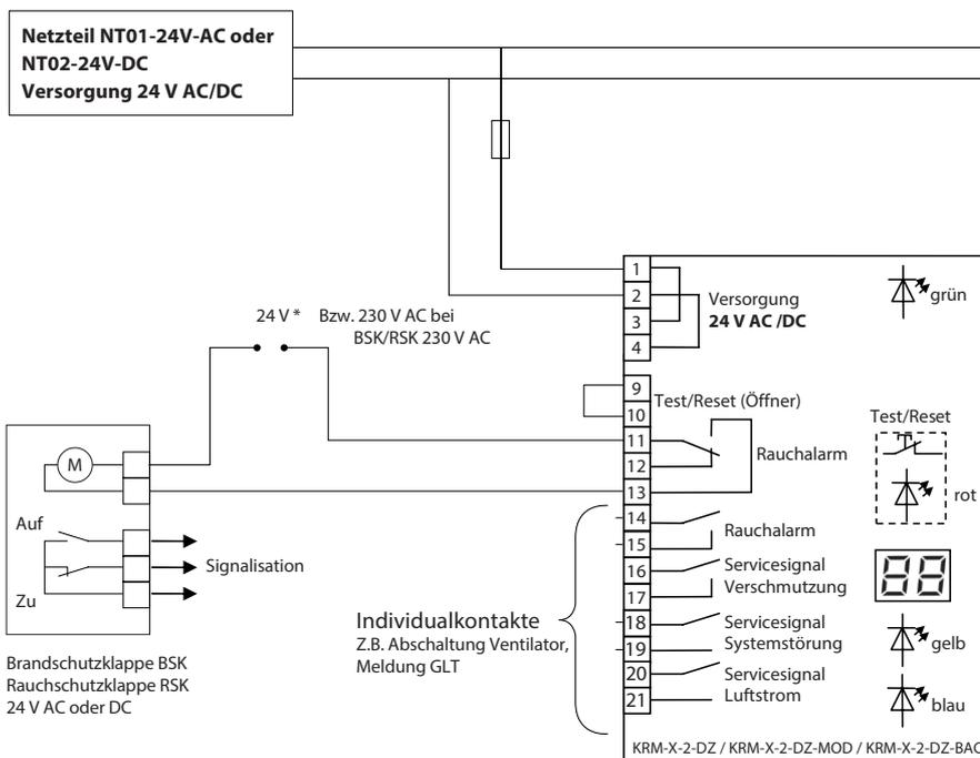
Ausführungsbeispiel der Verkabelung der BSK/RSK. Alternativ kann die BSK/RSK auch über Klemme 14 + 15 angefahren werden. Klemme 9 + 10 (Öffnerkontakt für externen Taster)
