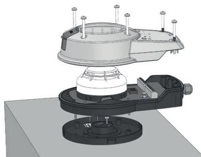
2. Durch Linksdrehen des weißen Melders auf dem Sockel um ca. 20° lässt sich der Melder abschrauben. Bei zu starker Verschmutzung (Anzeige > 70 %) sowie spätestens den nach Norm vorgeschriebenen Tauschzyklen, muss der Melder durch einen Austauschmelder ersetzt werden.
