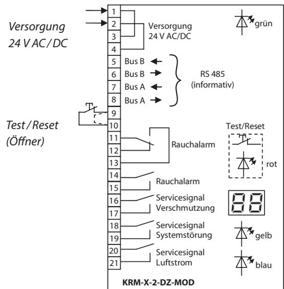
Alle KontaktDarstellungen in spannungslosem Zustand (Alarm) / kein Luftstrom vorhanden / Verschmutzung > 70 %.
