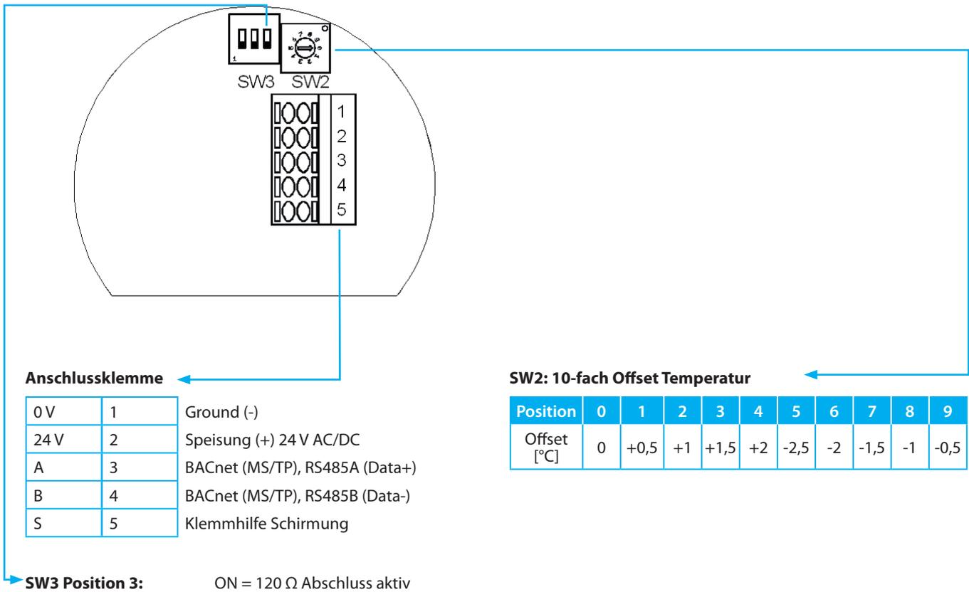
*ACHTUNG: Zur Programmierung / Adressvergabe, Einstellen der BACnet Device-ID und 5P-Kalibrierung muss einmalig ein Display verwendet werden.*
