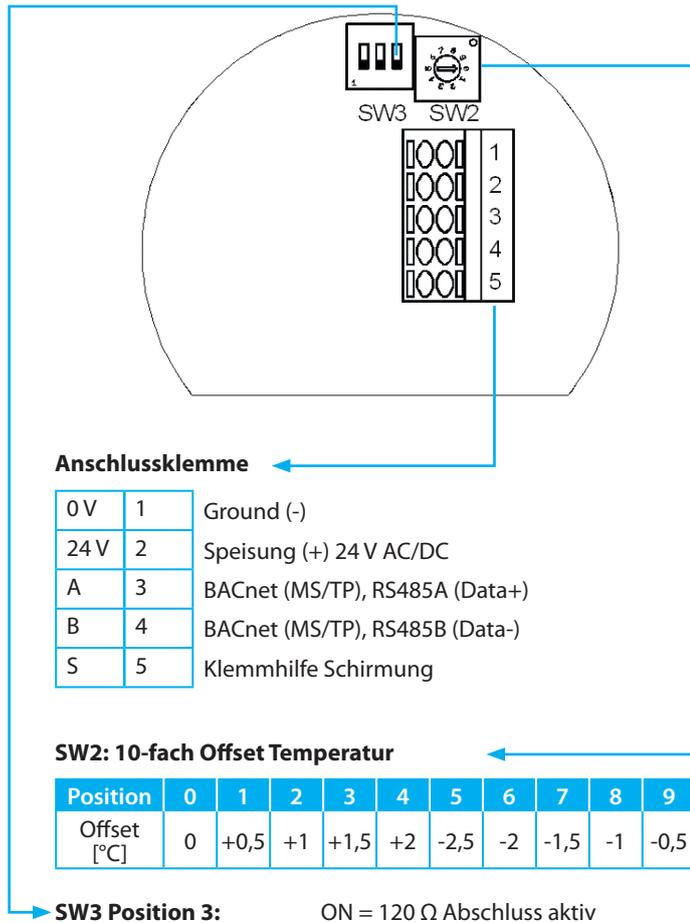
**ACHTUNG:** Zur Programmierung / Adressvergabe Einstellen der BACnet Device-ID und 5P-Kalibrierung muss einmalig ein Display verwendet werden.
