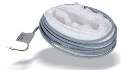
Das Sensorband wird mit einem wasser- und temperaturbeständigen Montageklebstoff auf die zu überwachende Oberfläche geklebt. Um einen Raum mit Wasserleitungen zu sichern, wird das Sensorband unterhalb der äußeren Seite der Isolation verlegt. Wenn die Leitung undicht ist, wird das Band feucht und löst somit den Alarm aus. Wenn das Sensorband feucht geworden ist, aber wieder getrocknet wurde, kann es normal weiterverwendet werden.
