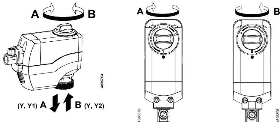
Stellungsanzeige in Position 1: Ventil offen      Stellungsanzeige in Position 0: Ventil geschlossen
