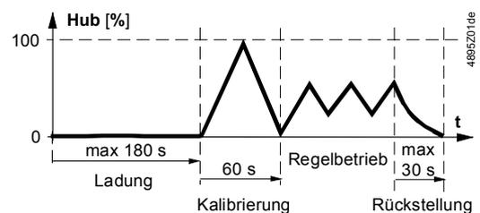
Während dieser Zeit kann der Antrieb nicht auf ein gleichzeitig anstehendes Y-Signal reagieren. Nach Abschluss des Ladevorgangs und der Selbstkalibrierung (siehe unten) verlaufen die Hubbewegungen für «Öffnen» und «Schliessen» proportional zum Stellsignal DC 0...10 V.
