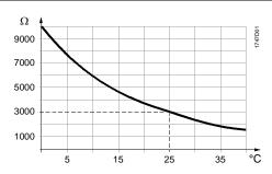
Der Sensor erfasst die Raumtemperatur über einen NTC-Widerstand. Der Widerstandswert wechselt aufgrund der Umgebungstemperatur. Die erfassten Werte stehen dann einem geeigneten Regler zur Verfügung.
