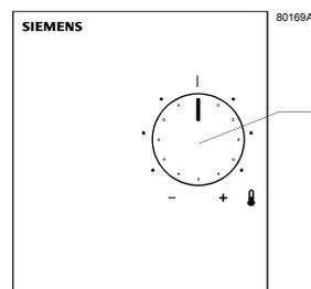
Drehknopf zur stufenlosen Änderung des Sollwertes
