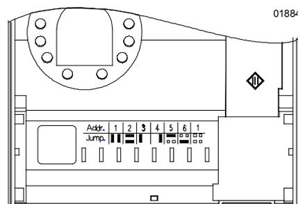
Adressstecker im Inneren des Gehäuses. Hier kann die Adresse eingestellt werden, wenn mehrere Raumgeräte am gleichen Regler angeschlossen sind. Die Geräte werden mit Adresse 1 ausgeliefert.
