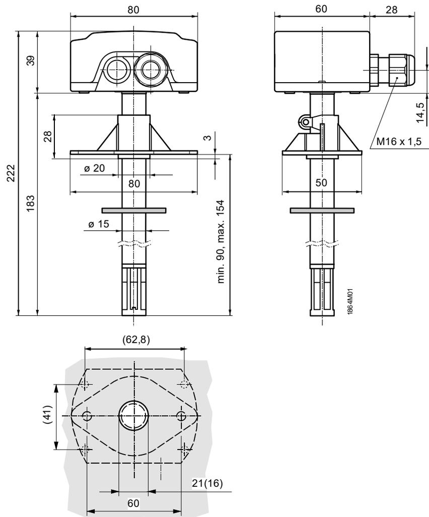
Montagebohrungen mit (ohne) Montageflansch
