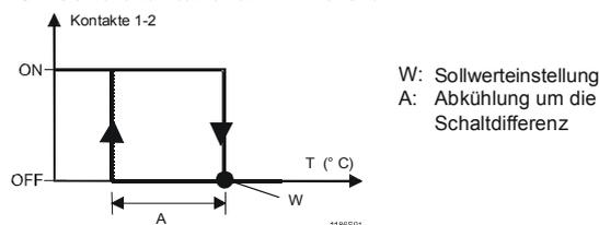
Bei Abkühlung des Fühlers auf eine Temperatur unter ca.  $-20^{\circ}\text{C}$  öffnet sich der Steuerstromkreis, schließt sich jedoch bei Temperaturanstieg wieder selbsttätig.
