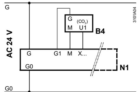
Steuer- und überwachungsseitige Anschlüsse
