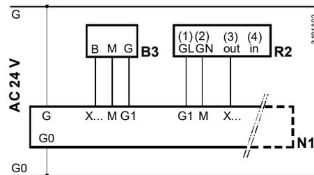
**Schaltpläne 3 und 4: Messteil mit CO<sub>2</sub>/VOC- und CO<sub>2</sub>-Auswertung**
