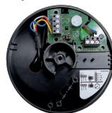
Integriertes Drehzahl Potentiometer
